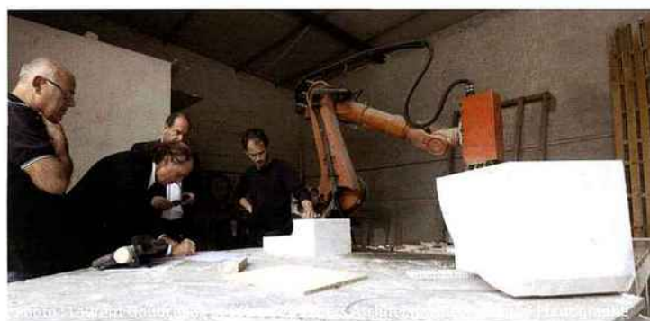
▲ Les modules de façade en marbre, presque tous de formes différentes, sont usinés dans les ateliers de Carrare, en Italie.
